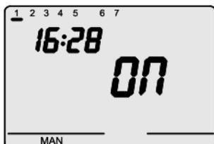
Per attivare la modalità di funzionamento manuale, premere il tasto MODE, finché sul display appare la scritta MAN.
