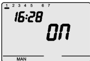
In modalità **manuale** è possibile impostare l'uscita in uno stato permanente. Sul display appaiono l'ora, il giorno della settimana, la scritta MAN e l'indicazione dello stato del relè (ON/OFF)
